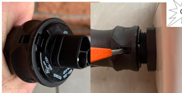
c) **Betteri-Steckverbindung** zwischen Wechselrichter (unten links) und 5m AC-Kabel (unten rechts) gem. Sammelbestellung:
