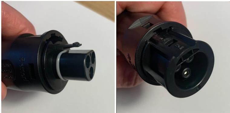
Auch hier auf „Click“ beim Stecken/Verriegeln bzw. auf vorsichtiges Trennen/Entriegeln mit Schraubendreher achten (Verriegelungsstift leicht herunterdrücken bei gleichzeitigem Ziehen):
